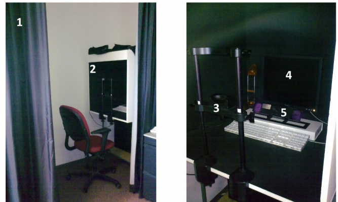
Fig. 6 Opstelling proef. 1. gordijn 2. donkere houten kast 3. kinsteun 4. beeldscherm 5. eyetracker
