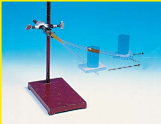
15.24 Een horizontaal trillend zaagblad. In het doosje zijn gewichtjes te plaatsen.
