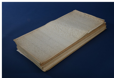
Figuur 2: Factoriseerstencils gebaseerd op kwadratische residuën, gemaakt door Derrick Norman Lehmer in 1929, foto van [Smi29]. Later bouwde Lehmer een elektronische versie met fotocellen.
