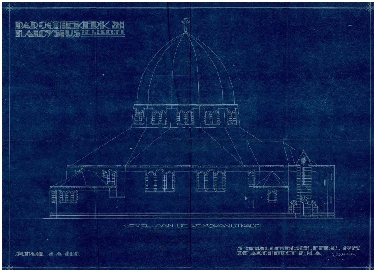
Afb. 24 & 25. Blauwdrukken van het voorlopige ontwerp, februari 1922. Op de interieurtekening (boven) is de stalen koepelconstructie ingetekend, maar heeft het interieur door een lager koepelgewelf en het ontbreken van de paraboolbogen een ander uiterlijk. Op de exterieurtekening (onder) ontbreekt de toren, maar oogt de koepel hoger.
