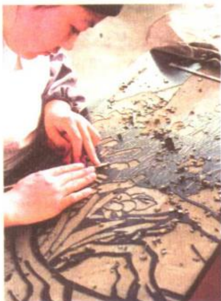
图 155 金地阳纹款彩漆屏风工艺程序③铲地 (摄影: 王虹军)
