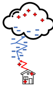
Figuur 5: De getrapte ladingen ontmoeten elkaar vlak boven de grond.
