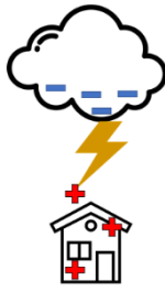
Figuur 1: Ontstaan van bliksem door de ontlading van elektriciteit die voortvloeit uit het verschil in elektrische lading tussen de wolk en de grond.
