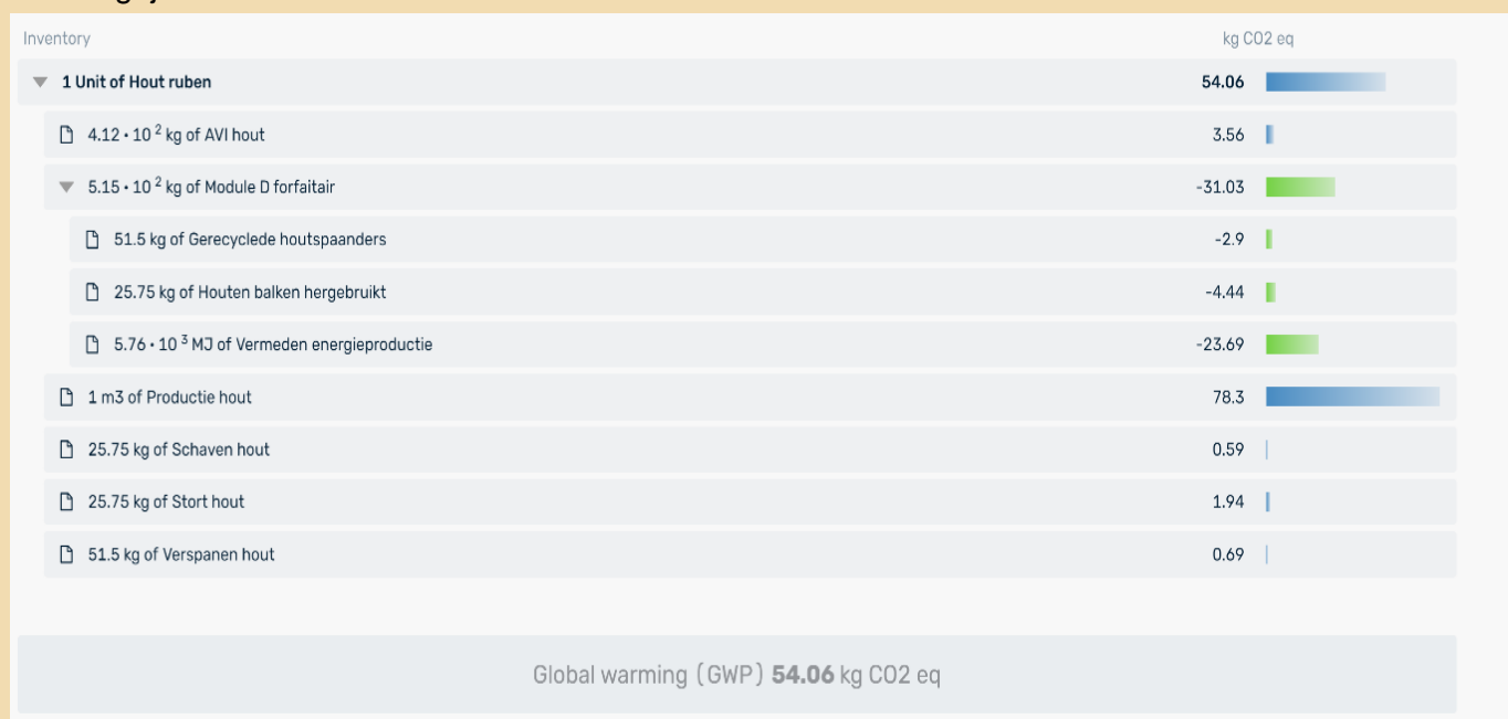
Figuur 6: GWP berekening voor een scenario van een kuub Hollands naaldhout, gezaagd, gedroogd, (=constructiehout; 515 kg/m 3 , vochtgehalte 12%) bij houthandel, Staatsbosbeheer(NMD v3.3), waarin de standaard forfaitaire waarden meegenomen worden voor de afval en recycling fase binnen module D. Hier wordt dus 5% gestort, 80 % verbrand in een AVI, 10% verspaand en 5% geschaafd en hergebruikt.
