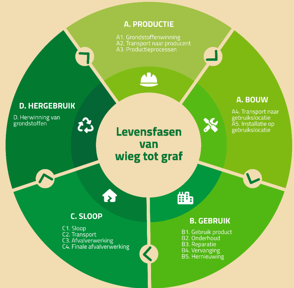
Figuur 5: Binnen de bepalingsmethode van de NMD worden de volgende vier stadia (A1-3, A4-5 B1-7 en C1-4) en een module D aangehouden tijdens de levensfasen van een product/materiaal.
