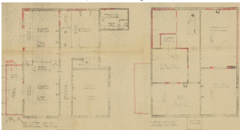
Afb.40 Frederikstraat 8, plattegrond begane grond en verdieping in 1945, rood is oorlogsschade. Geldersarchief, bouwaanvraag 2508-1, 174-22.
