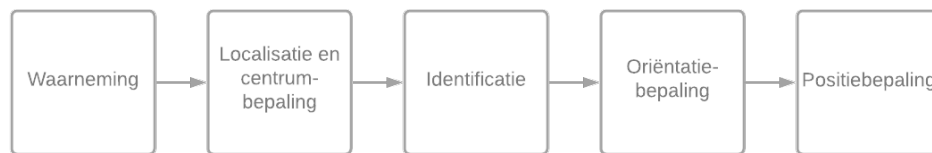
Figuur 3.1: Van waarneming naar positiebepaling. De oriëntatiebepaling kan i.c.m. een inclinometer worden gebruikt om een positiebepaling te doen.
