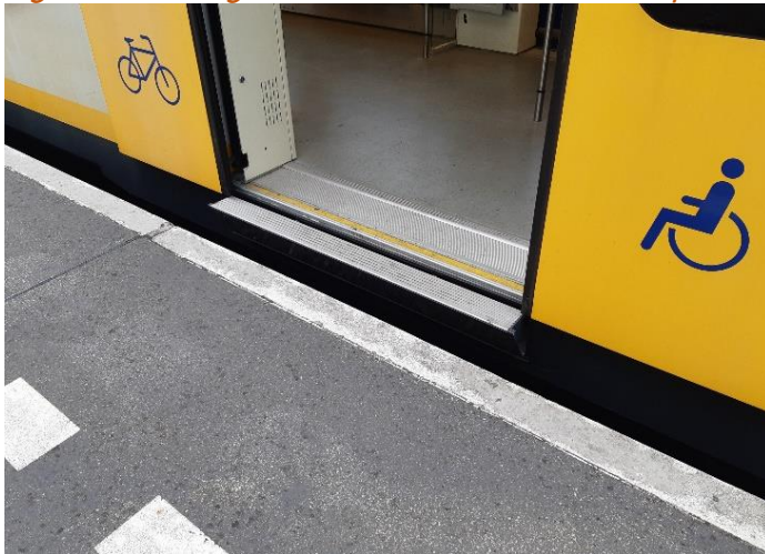
Figuur 3.5: Het gat tussen een SLT-trein en het perron te Utrecht Terwijde.
