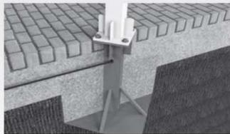
Le socle solide (dimensions 50 x 50 x 50 cm) garantit une stabilité permanente (enterré + béton).
