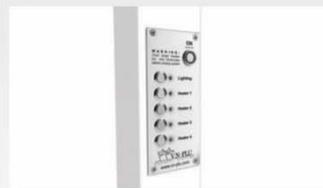
Deze elektronische schakelaar heeft een aantal vaste schakelstanden, bijvoorbeeld 30 minuten, 120 minuten of permanent. 230/400V, 5 x 14Amp schakelbaar; IP65
