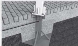
Het gedegen voetstuk (afmeting 50x50x50cm) garandeert een permanente stabiliteit (ingraaf + beton).
