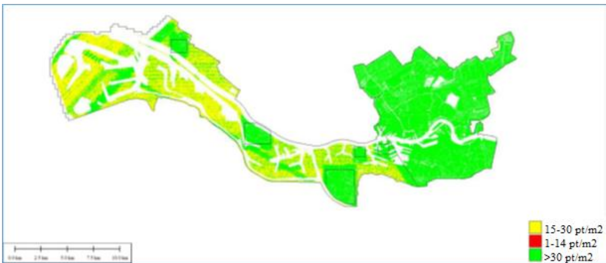
Figure 5.11: Point density of Hoogtebestand Rotterdam 2018 (source: Gemeente Rotterdam)
