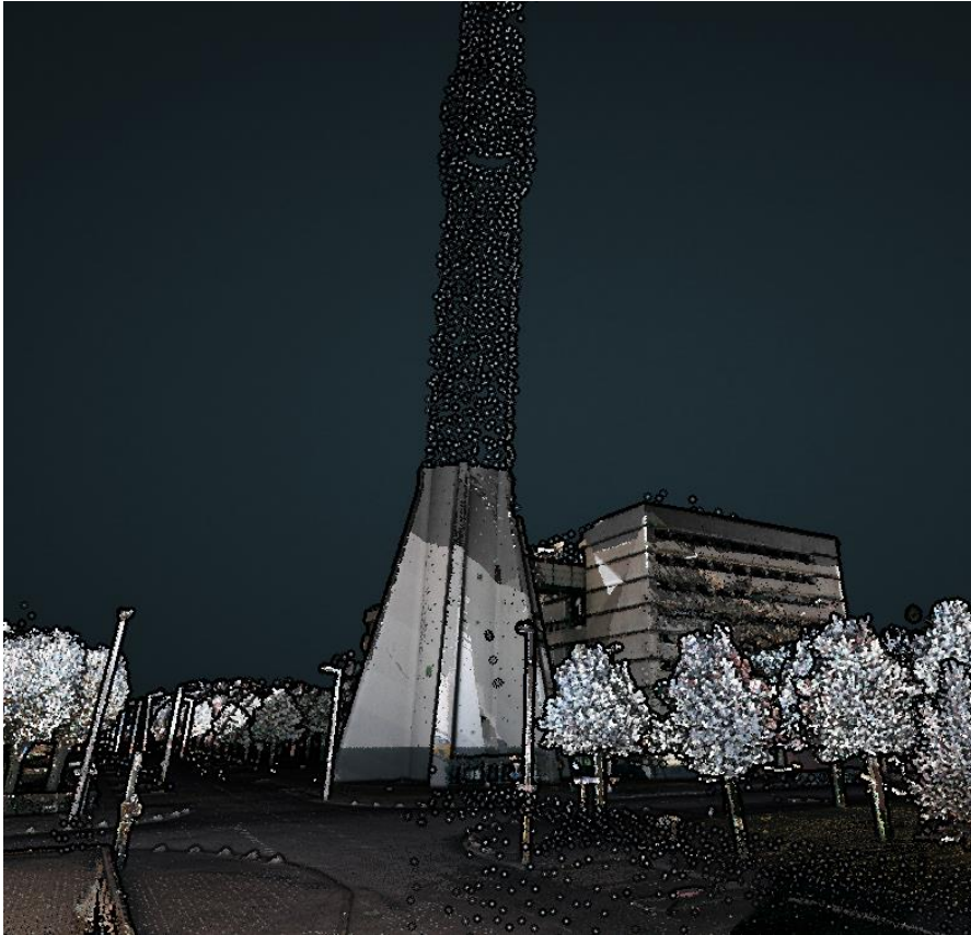
Figure 5.4: Overlay of ALS and MLS point clouds in Pointer (source: Gemeente Rotterdam / own work)
