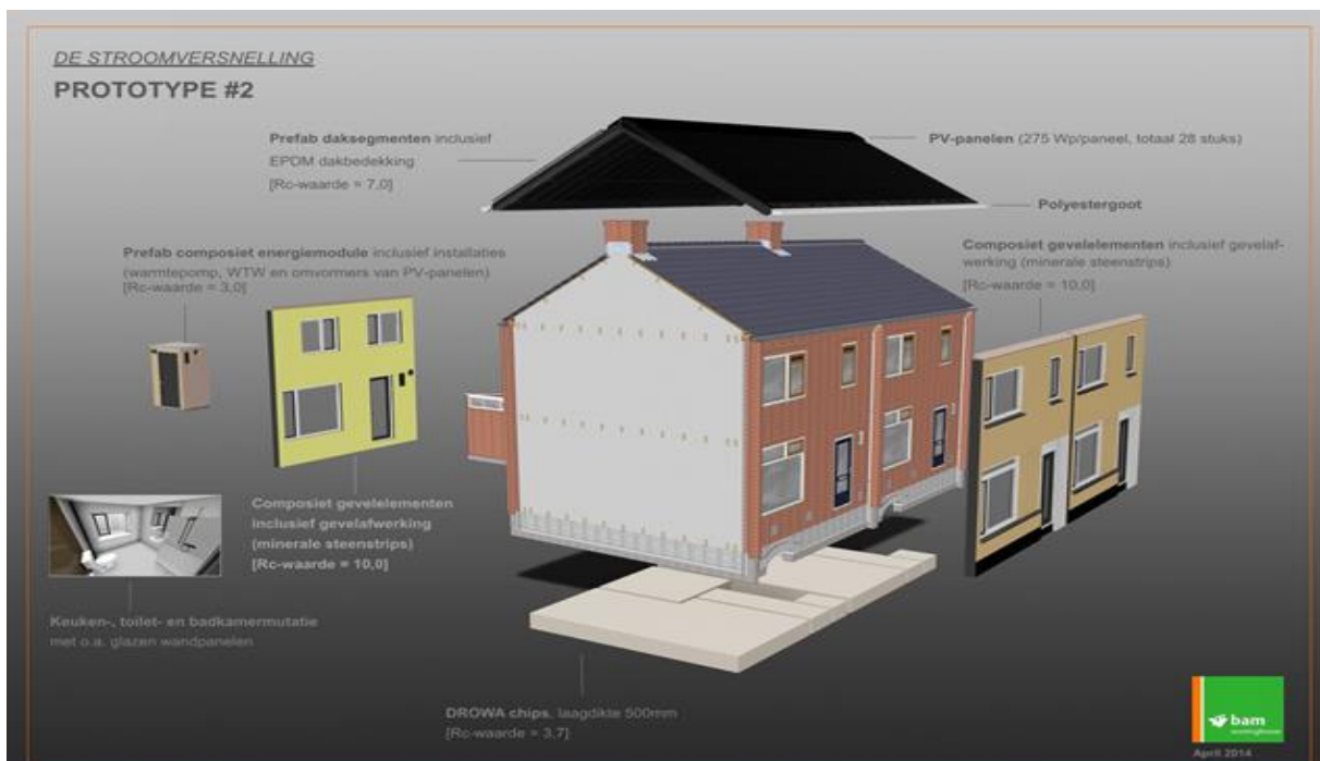
Figuur 13: Schematische weergave van een NOM-renovatieverbouwing (BAM Wonen, 2018B)
