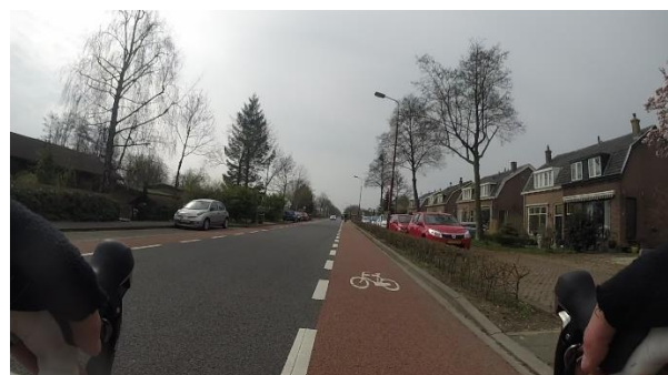
Afbeelding 2: Voorbeeld van een fietsstrook
