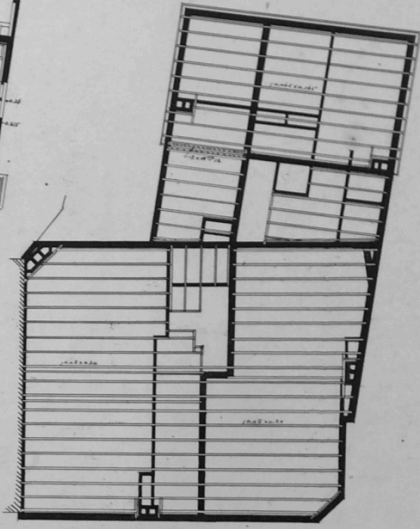
Balklaag 1 ste Verdieping
