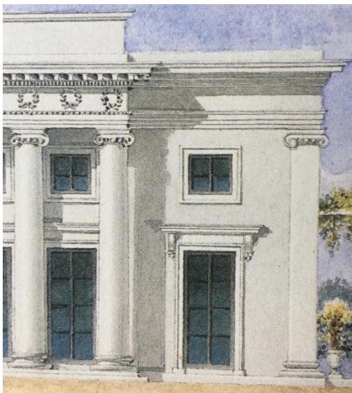
Afb. 23a. Detail vensterlijstwerk en consoles.
