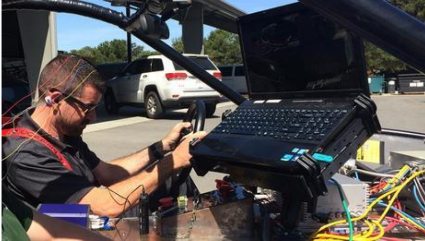
Figuur 9 EEG apparatuur meet de concentratie via hersenactiviteit van een bestuurder in een zelfrijdende auto
