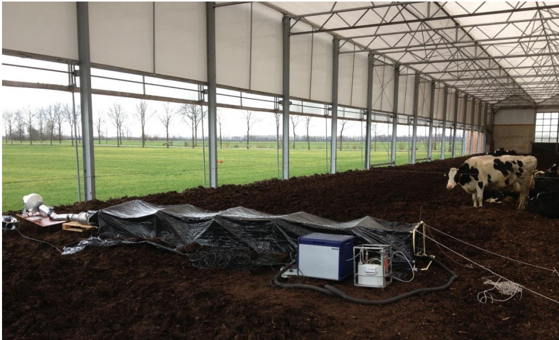
Figuur 1: Meetopstelling ammoniakemissie grote bedding op 10 februari 2014
