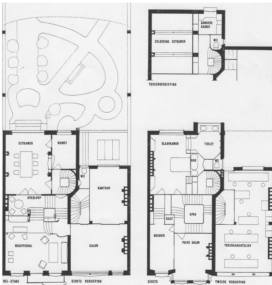
Afb. 26. Plattegrond Hortahuis (1898-1902), rue Américaine 23-25, Brussel. Rechts: eerste verdieping met slaapkamer en badkamer aan de achterzijde.
