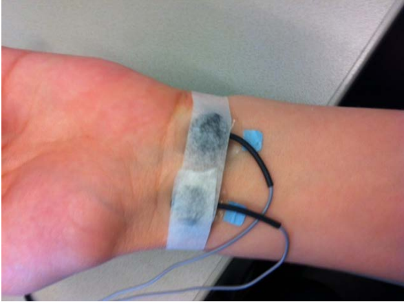
Foto van de elektroden die de huidgeleiding meet.
