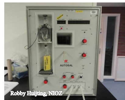
Figuur 38 Men gebruikt een Guildline Autosal 8400B om de monsters door te lezen en daarmee de saliniteit aan de hand waarvan de data gekalibreerd wordt te bepalen.
