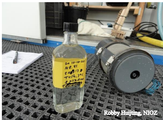
Figuur 37 De monsters worden genomen vanaf het steigerplateau. Om zoveel mogelijk vuil te weren, wordt de fles waarmee het water wordt verzameld aan een filter bevestigd tijdens het bemonsteren.
