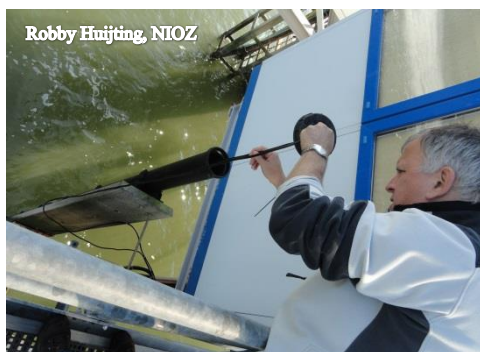
Figuur 36 De FYS sensor zit bevestigd achter de oostelijke cabine van het NIOZ steiger plateau. Deze koker is weer bevestigd aan een paal. De bodem van de koker is alleen te zien tijdens laagtij.
