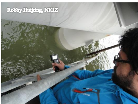
Figuur 35 De metingen met de Testo 110 worden, net als de controlemetingen met de VWR EC300, verricht vanaf de trap van de NIOZ steiger. De bemonstering vindt op het plateau plaats.
