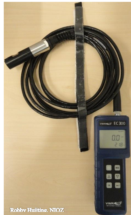
Figuur 33 De gebruikte VWR EC300 temperatuur/conductiviteit/saliniteit handmeter.
