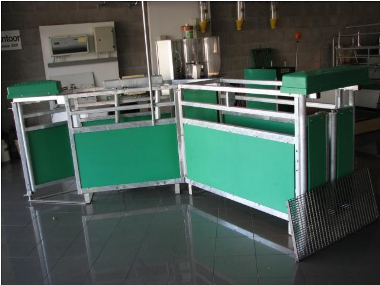
Mannebeck voerstation.(4) Vergelijkbaar als het model dat wordt gebruikt in de drachtige zeugenstal van de Tolakker.
